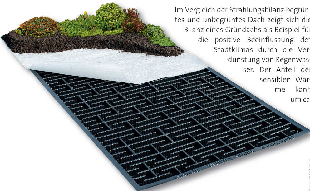
(3) Optigrün-Systemlösung Retentionsdach Mäander 30: Abflussverzögerung durch den schlängelinienförmigen Abfluss des Überschusswassers in der Mäanderplatte. Wasserrückhalt bedeutet Kühlung.
