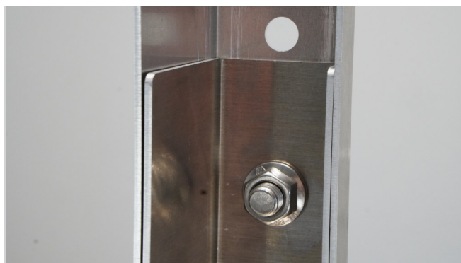
Abbildung 20: Sicherung des Bügels mit Schraube und Flanschmutter.
